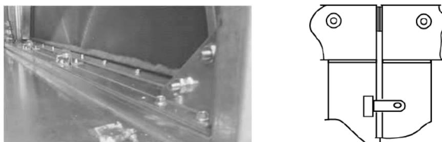
Рисунок 2 – Соединение секций установки
